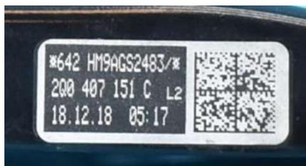
2019 T-ROC Etiquetado del triángulo inferior.
